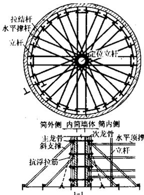
图 4 内筒模板支撑体系
